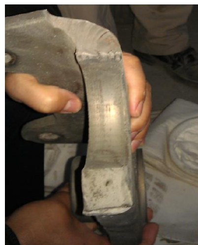
图4、5 A厂循环提升机柱销断裂
