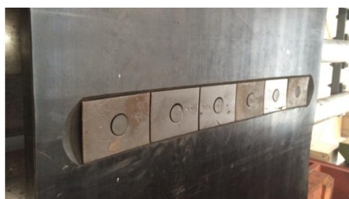
图5 钢丝胶带的背部凹槽和方头料斗螺栓
