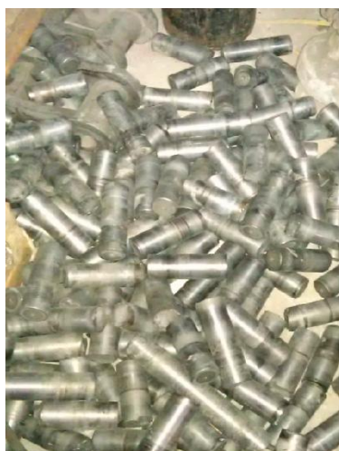
图4、5 A厂循环提升机柱销断裂
