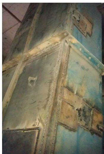
图 2、3 A 厂中央链辊压机循环提升机使用情况
