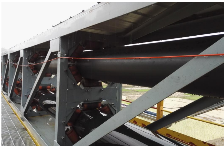
图 2 D350 圆管带式输送机成管段（上管输送石灰石、下管为返回管）
